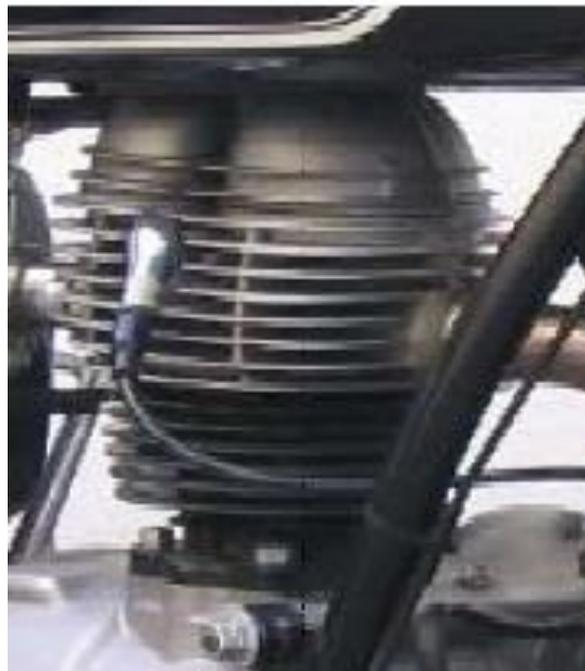
В моторе мотоцикла подобные рёбра служат для его охлаждения
