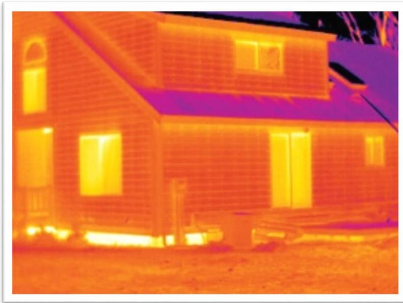
Термографическая камера позволяет обнаружить утечки тепла в зданиях и сооружениях, на теплотрассах, выявить перегревшиеся контакты и изоляторы в электрических сетях, выработавшие свой ресурс или неправильно установленные приборы и оборудование на промышленных предприятиях.
